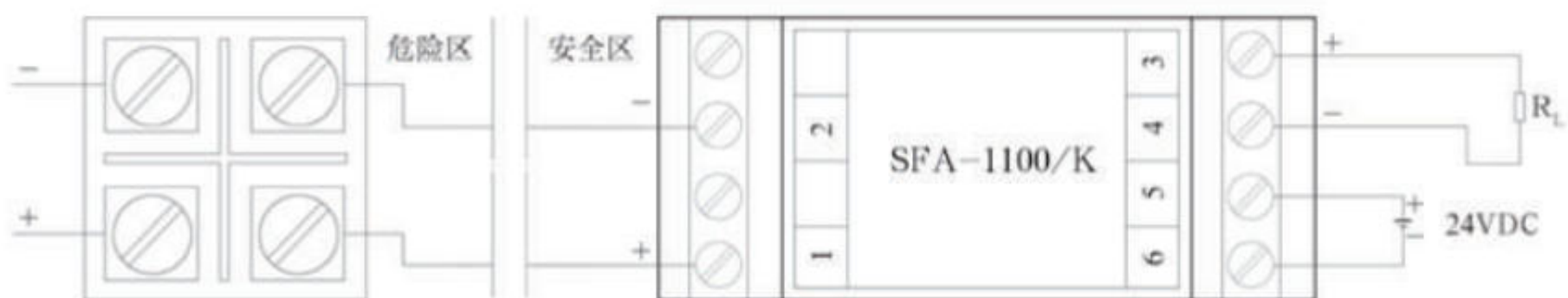
图26流量计与隔离式安全栅接线图
