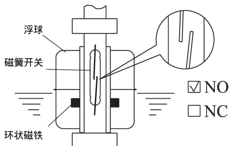
图2、常开 (NO) 触点，当液位上升时磁簧开关接通
